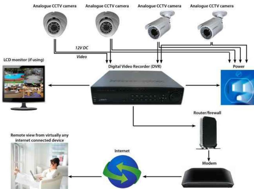
Gambar 4. Skema Pemasangan Alat Pengaman berbasis Vision
