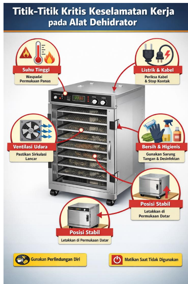
Gbr 3. Titik-Titik Kritis Keselamatan Kerja pada Alat Dehidrator
