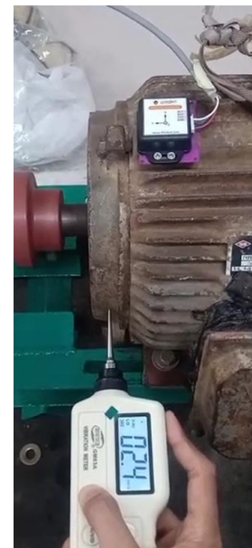
Gambar 7. Gambar Pengambilan Data Menggunakan Alat Ukur Vibrometer GM 63A dan Sensor WT61PC ( Drive End )
