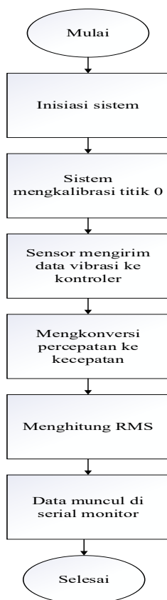
Gambar 3. Flowchart sistem monitoring vibrasi motor induksi 3 fasa
