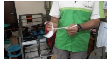
Gambar 10. Pemasangan Kertas Nomex pada Kawat
