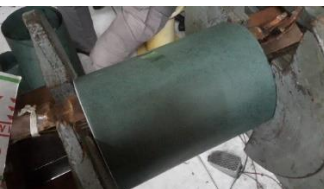
Gambar 8. Pemasangan Kertas Prespan untuk Lapisan Awal
